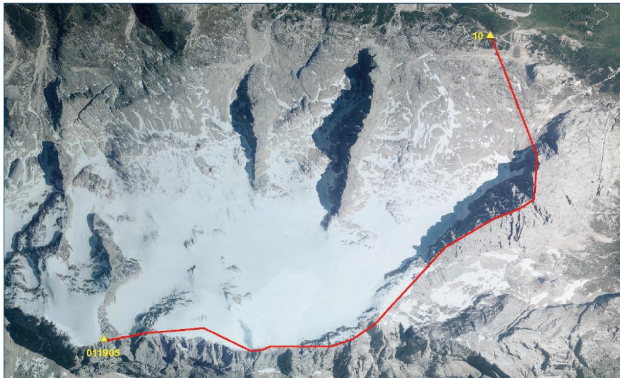
**Figura 11** - Linea di confine ricavata dalle mappe catastali austriache riportata sullo sfondo delle ortofoto AGEA.
