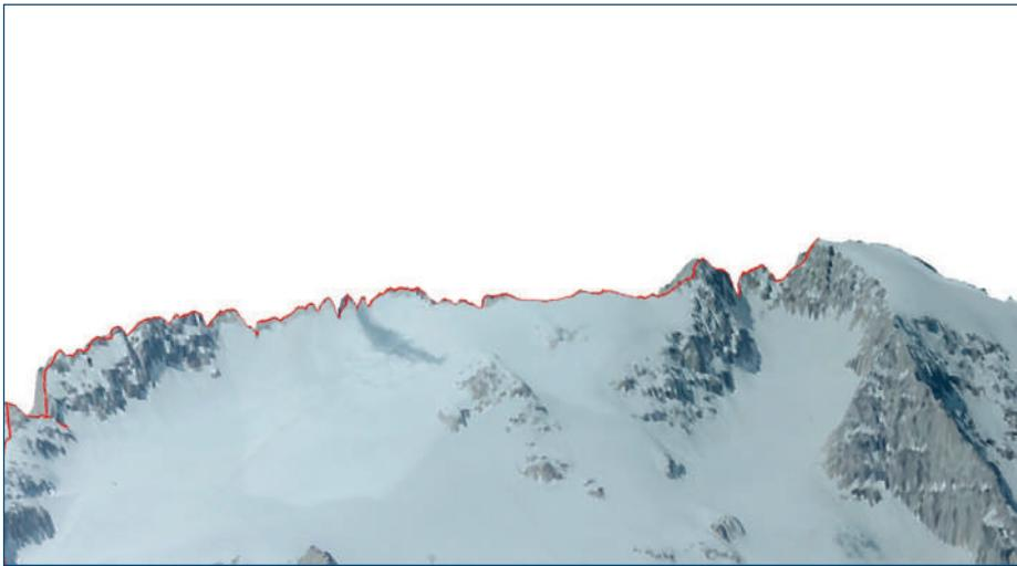
**Figura 14** - Linea di cresta restituita nel tratto Punta Penia - Punta Serauta (a sinistra), riportata sulle ortofoto AGEA modellata su DTM
