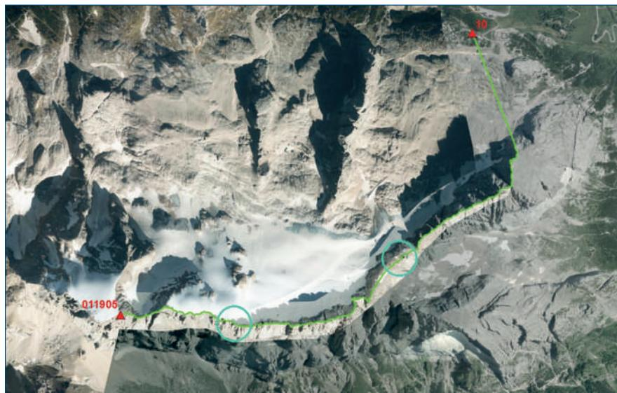
**Figura 16** - Linea definitiva del confine: i triangoli rossi sono i punti di coordinate note iniziale e finale, i cerchi in celeste indicano le zone con presenza di edifici.
