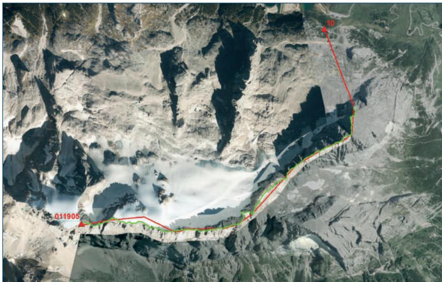
**Figura 15** - Confronto fra la linea di cresta attualmente restituita (in verde) e la linea di confine ricavata dalle mappe austriache (in rosso), sullo sfondo delle ortofoto AGEA; i triangoli rossi sono i punti di coordinate note iniziale e finale
